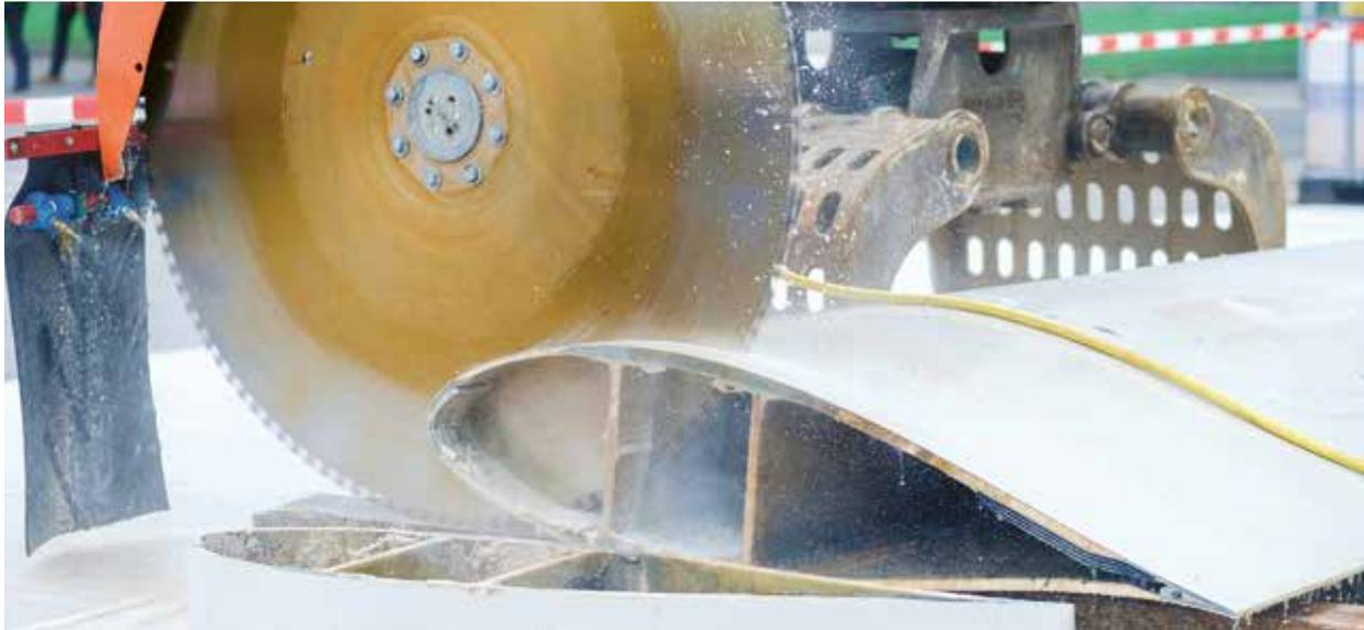
GFK-Rotorblattsegmente werden in Behandlungsanlagen (dezentral und bundesweit) für den Weitertransport in die Verwertungsanlage neocomp GmbH in Bremen vorbereitet. In dem Zuge werden auch massive Eisenmetalle entfernt, die bei der weiteren Aufbereitung stören würden.
