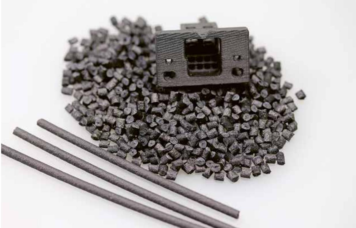
Abb. 2: Granulat, Filament und gedruckter Demonstrator (Steckergehäuse) aus rezykliertem ABS und rezyklierten Kohlenstofffasern
